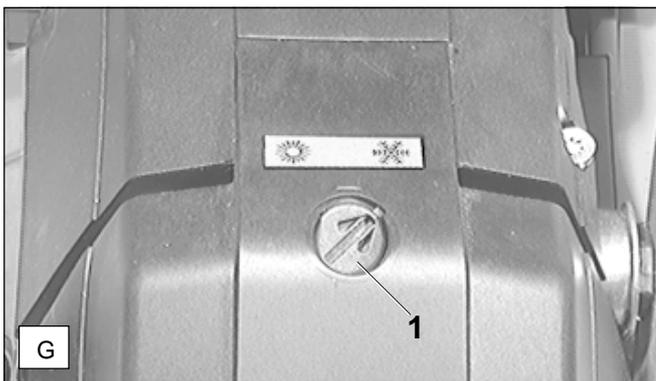
Pour éviter un givrage du carburateur dans des conditions hivernales, on peut amener de l'air chaud du cylindre vers le carburateur.
