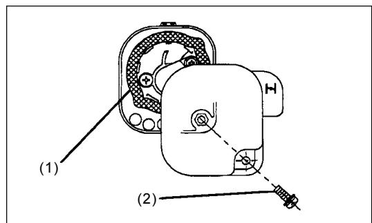
**NOTE :** Si la poussière et la saleté adhérant au filtre à air sont excessives, le nettoyer tous les jours. Un filtre à air bouché peut rendre le démarrage du moteur ou l'augmentation de la vitesse de rotation du moteur difficile ou impossible.
