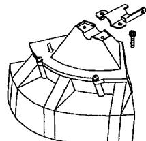
—Fixer le dispositif de protection (1) sur le collier de serrage (3) au moyen de deux boulons M6 x 30 (2).
