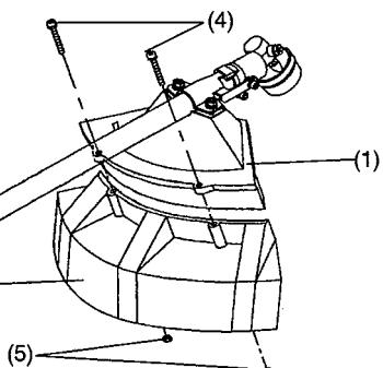
–Cuando se utilice el cabezal de corte de nylon, ajuste el protector (6) dentro del protector (1) y apriételos con dos tuercas (5) y dos tornillos (4).
