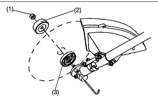
REMARQUE: La rondelle de serrage (2) et l'écrou (1) ne sont pas indispensables pour le montage de la tête de coupe à fil. La tête de coupe à fil doit venir se placer sur la rondelle d'accouplement (3).
