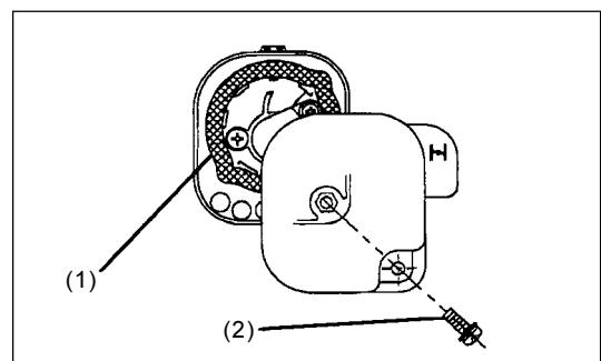
**NOTA:** Si hay polvo o suciedad excesivo que adhiere al filtro de aire, límpíelo cada día. Un filtro de aire estorbado puede hacerlo difícil o imposible arrancar el motor o de incrementar la velocidad rotatoria del motor.
