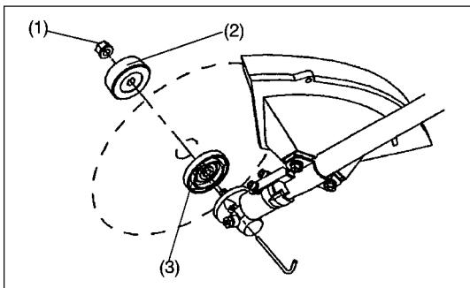
NOTA: La arandela de sujeción y la tuerca no son necesarias para montar el cabezal de nylon.
