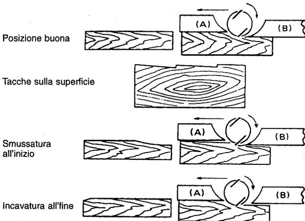
I bordi delle lame sono perfettamente paralleli alla superficie del piano.
