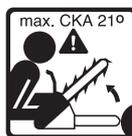
Angle maximum de choc de recul calculé (CKA)\* sans frein de chaîne, avec les combinaisons de barre et de chaîne recommandées (ici, l'angle CKA est de 21°).
