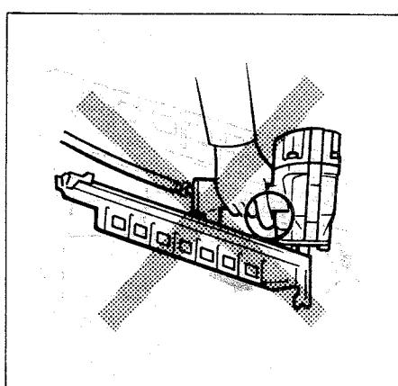
Maniez votre outil avec soin, étant donné qu'il contient de l'air à haute pression et que toute fissure (causée par un maniement négligent) est source de danger. N'essayez pas de graver à la surface de l'outil.
